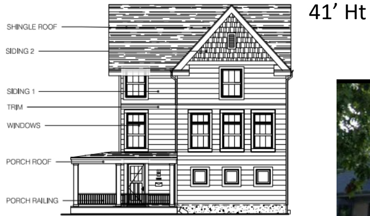
A SIDE ELEVATION SCALE: 1/4" = 1'-0"
